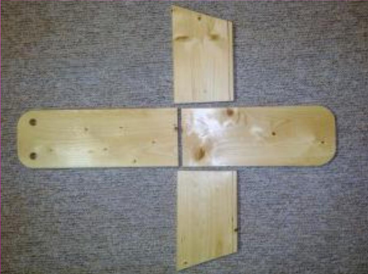
Zuerst wird ein Seitenteil mit der Bodenplatte verschraubt. Anschließend werden das andere Seitenteil und die Rückwand angeschraubt.
