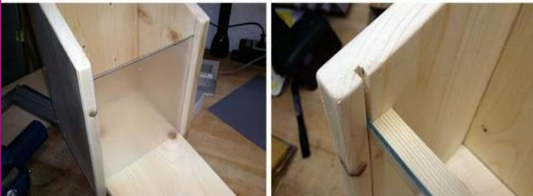
Zur Verstärkung und Stabilisierung der Oberkante wird eine Vierkanteleiste hinter die Scheibe gesetzt und von außen angeschraubt. Auch hier können eure Eltern die Schraubstellen an den Seitenwänden vorbohren. Alternativ können sie die Vierkanteleiste auch mit der Scheibe selbst verschrauben. Dann lässt sich die Leiste oben herausziehen, wodurch sich der Kasten später reinigen lässt, ohne dass ihr ihn abnehmen müsst.
